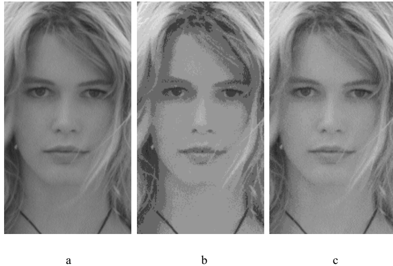
Obr. 1.2 Obráz Claudia 256 x 140 obrazových bodov s 256 úrovňami jasu (a), ten istý obraz kvantovaný lineárne na 16 úrovni jasu (b), nelineárne (c)
