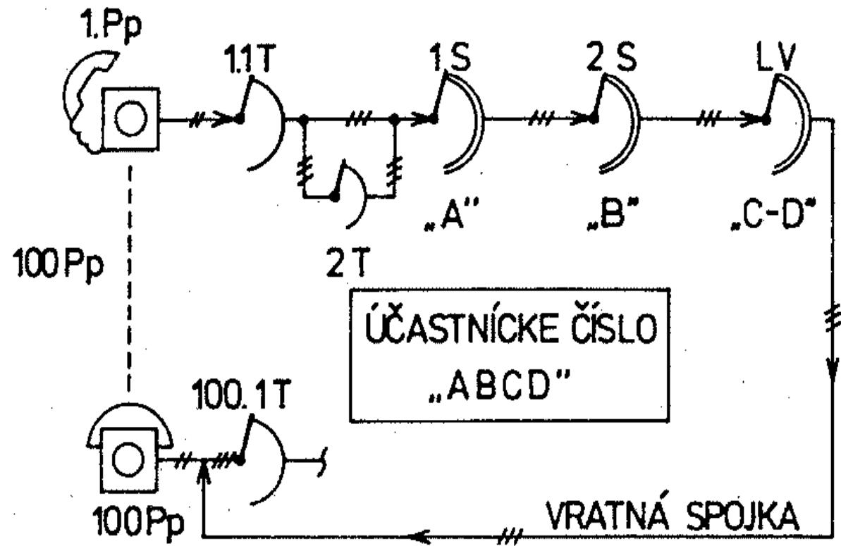
Vnútorné spojenie v synchronnej ústredni
