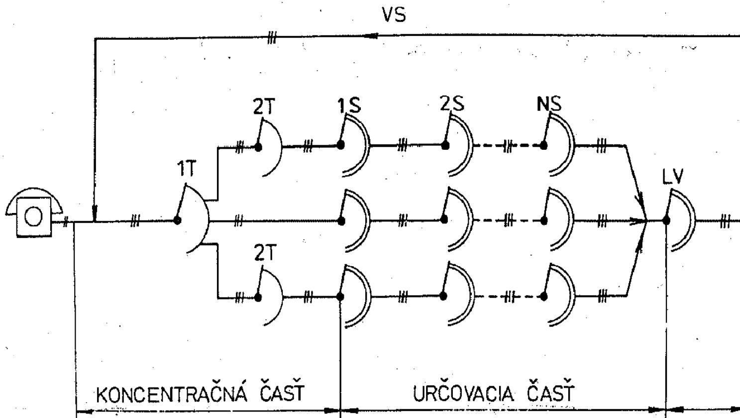
Rozdelenie spojovacieho pola synchronného systému
