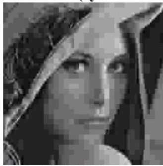
b) DCTII, bloky 8x8, SPIHT, 0.139 bit/bod, MSE: 203.38
